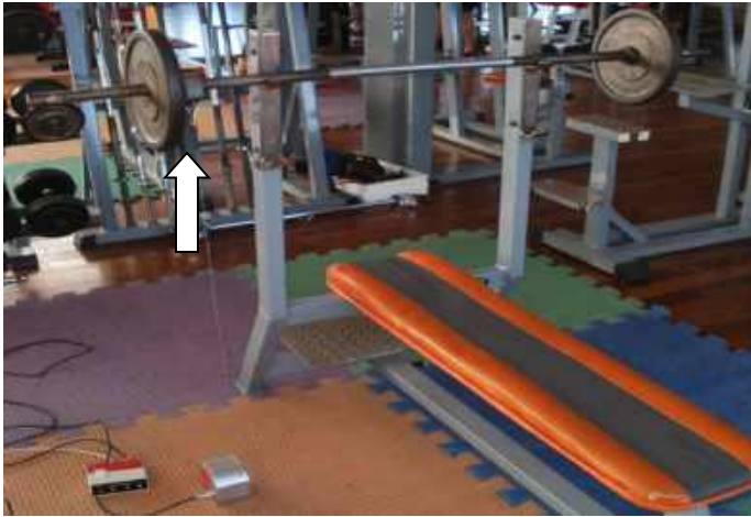
Fig. 9 Encoder colocado en un press de banca mediante un velcro a la barra.
