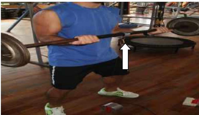
Fig. 10 Encoder colocado en una barra en su parte medial para la evaluación de un curl bíceps con barra.
