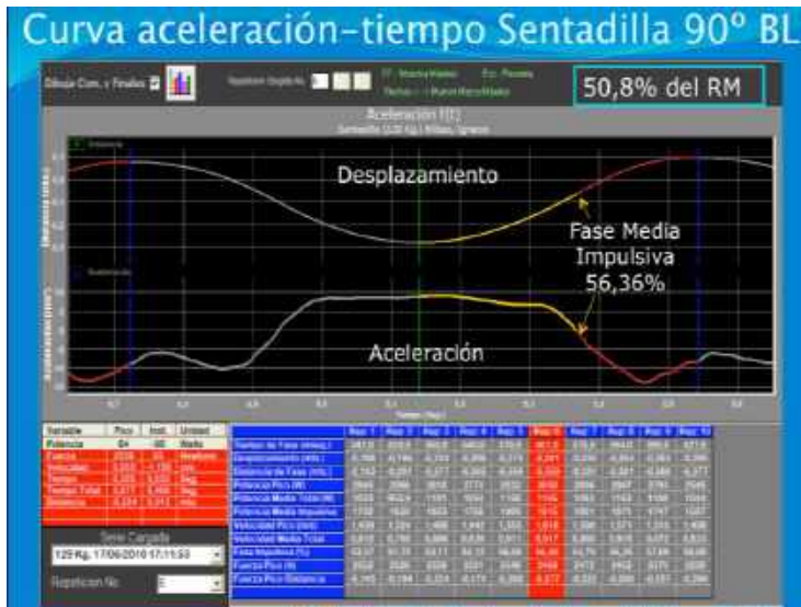
Figura 13. Comportamiento de una curva de aceleración al 50,8% de 1RM a la máxima intención. La línea (Vertical) marca el inicio de la acción concéntrica y la Azul (Vertical) el final. La Fase Media Impulsiva explica durante cuanto % (56,36%) de Tiempo, del total de la fase, se realiza trabajo mecánico.
